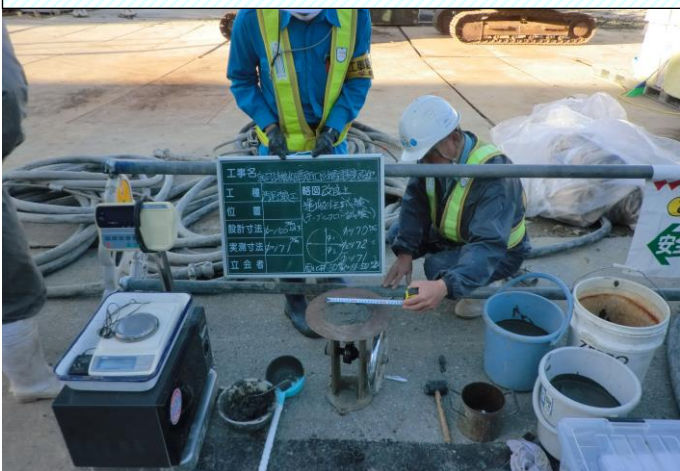
改良土の運搬性試験（テーブルフロー試験）
